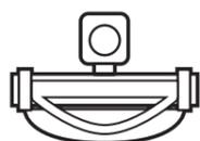
Los Caudalímetros Coriolis resultan muy caros, y debido a su tamaño y su peso no son manejables. Puesto que la tubería se va estrechando cada vez más, los depósitos de producto pueden llegar a acumularse.
